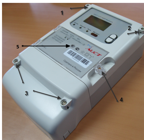
Рисунок 4 – Фотография общего вида электронных счётчиков активной и реактивной электрической энергии АИСТ А300-D, где 1 – пломба ОТК завода-изготовителя; 2 – пломба поверяющей организации (место нанесения знака поверки); 3 – пломба энергоснабжающей организации. 4 – пломба эксплуатирующей организации. 5 – место нанесения знака утверждения типа
