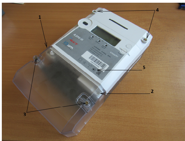
Рисунок 6 – Фотография общего вида электронных счётчиков активной и реактивной электрической энергии АИСТ А300-Н, где
